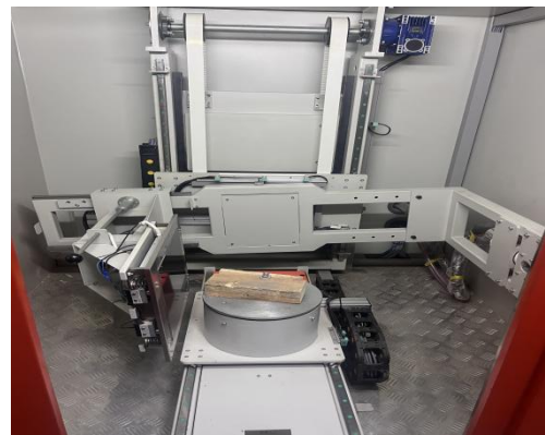
铅房内部 X 射线实时成像系统
